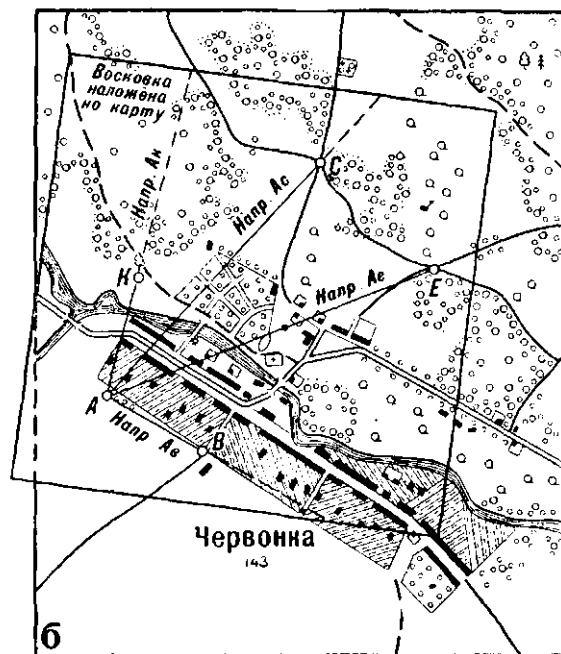
Рис. 161. Перенос точек с аэроснимка на карту способом Болотова:
