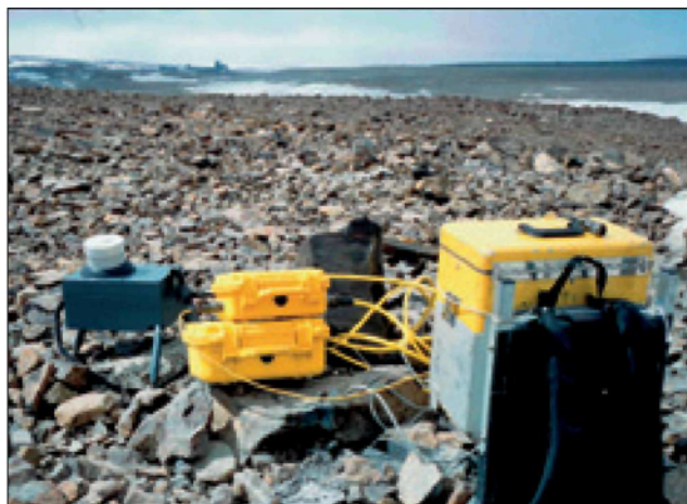
Рисунок 3 Прототип трехосевой системы LANDTEM,
