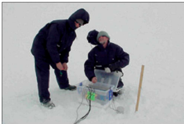
Рисунок 2 Система трехосевых аэродатчиков CSIRO SQUID, развернутая для первоначальных испытаний в Raglan, Квебек, Канада в мае 2000. Датчики SQUID были расположены под снегом для уменьшения шума, вызванного ветром.
