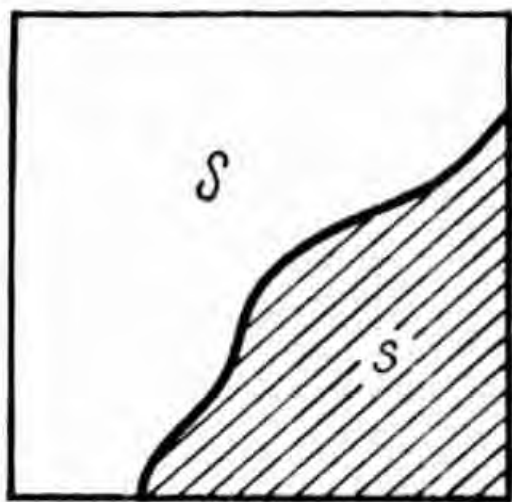
Рис.72. Схема определения площади по А.Н.Савичу
