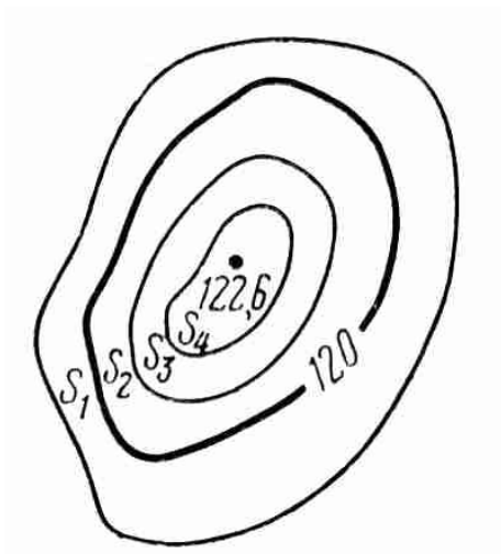
Рис.66. Схема определения объемов земляных тел.
