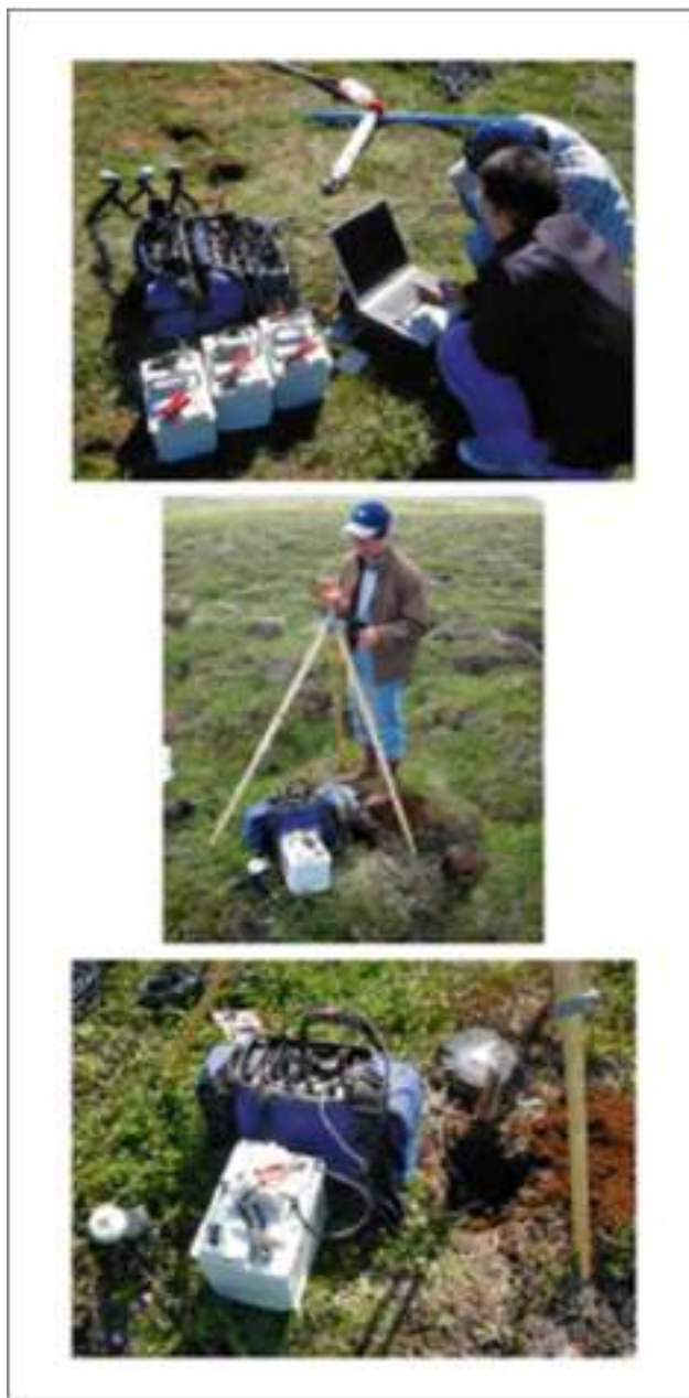
Рис. 7 Полевой отряд, собирающий МТ станции.
