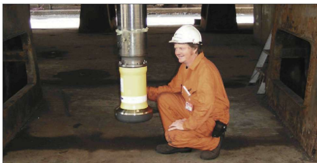
Установка приемопередатчика USBL на корпусе буфера. Этот метод обычно используется, когда система должна быть постоянно установлена на судне.
