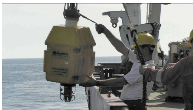
Размещение подводного приемопередатчика во время процедуры калибровки системы USBL.
