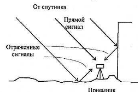
Рис. 4.2. К пояснению влияния многопутности сигналов, попадающих на вход приемника
