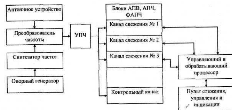
Рис. 1.13. Упрощенная функциональная схема многоканального GPS-приемника
