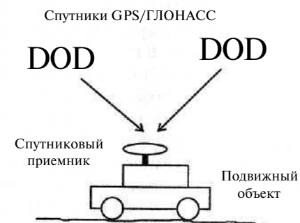
Рис. 8.5. Автономный режим определения местоположения подвижной станции в реальном времени
