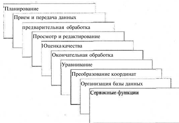
Рис. 6.4. Общая структура программы обработки фирмы-изготовителя спутниковых приемников
