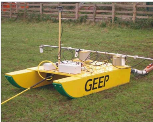
Рис. 10 Современные сани GEEP с несколькими датчиками Caesium магнитометра, DGPS антенна и измерительное устройство электропроводности ЕМ на буксируемом стингере.
