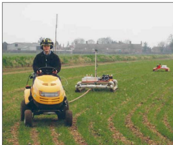
Рис. 4 Съемка с GEEP, буксирующим измерительный прибор удельной электропроводности. Генераторная установка и DGPS установлены на задней стороне саней, а приемник и второй DGPS – на передней. Антенна беспроводного LAN для связи с базовой станцией четко видна над левым плечом водителя.
