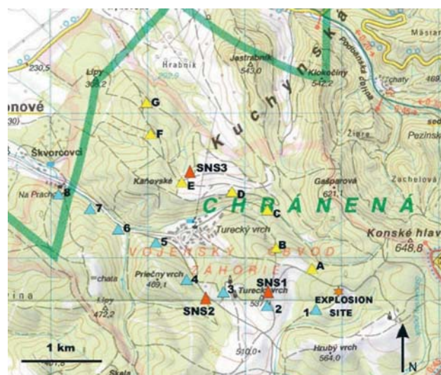
Рисунок 3 Участок Stupava DE04. Взрывы были произведены штабом Армии в точке в красной звездой. Схема отдельных 3C сейсмоприемников по линиям (1-8) и (A-G), SNS малые группы были установлены в точках с кратными треугольниками.
