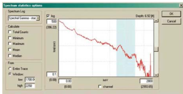
Окно статистических спектральных данных по 1024 каналам данных спектрального гамма зонда для модели UI (2.6% eU 3 O 8 ) Grand Junction, CO, USA.
