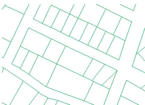
Вы исправили три ошибки, которые были нарушениями правила “Не должны иметь висячих узлов”. В каждом случае ошибка была исправлена путем редактирования геометрии линии границы участка: сокращением, растяжением или удалением линии.
