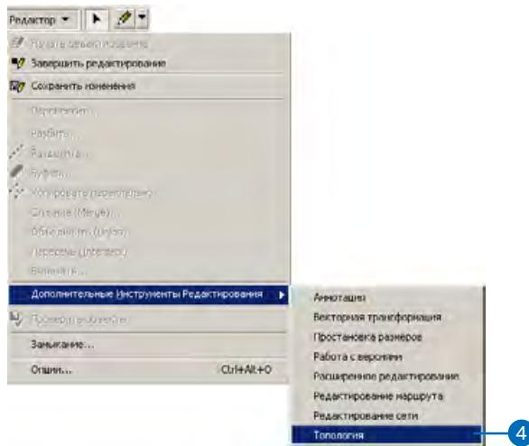
Панель инструментов Топология содержит инструменты для работы с топологически связанными объектами. Объекты могут быть связаны топологией, хранящейся в базе геоданных. В ArcInfo и ArcEditor вы можете использовать инструменты панели Топология для редактирования топологий базы геоданных. Для получения дополнительной информации по этому вопросу просмотрите упражнение “Использование топологии базы геоданных и главу “Редактирование топологии” в книге *Редактирование в ArcMap*.
