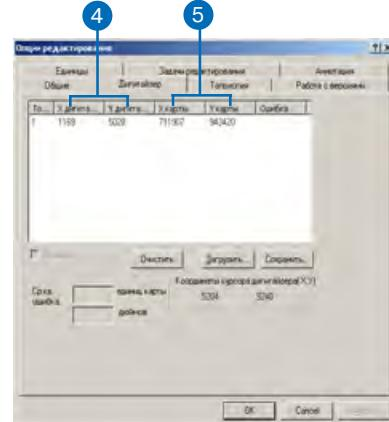
6. Двигаясь по часовой стрелке, щелкайте на каждой из трех оставшихся опорных точек на вашей бумажной карте. После оцифровки каждой опорной точки вводите фактические базовые координаты в поля X Map и Y Map.
