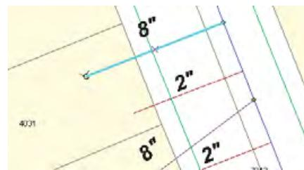
Первое, создается объект соединения между магистральной трубой и подводящей трубой гидранта, и они топологически связаны в сети. При создании этой сети было задано правило связности между этими типами объектов, которое определяет соединение по умолчанию, поэтому новое соединение является соединением по умолчанию, в данном случае - объектом вентиля.
