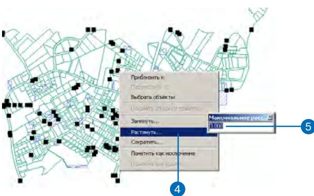
Процесс может занять некоторое время, так как все объекты с висячими узлами будут проверяться на предмет наличия в пределах трех метров от висячего узла объекта, до которого можно было бы продлить линии.
