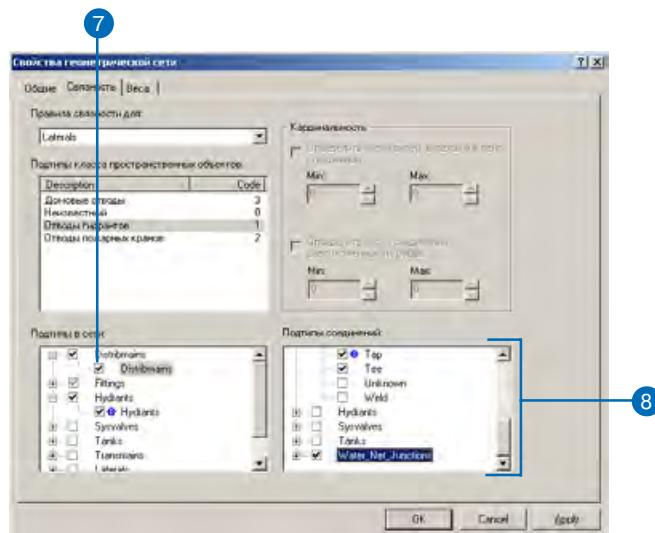
Поскольку вы отметили ребро в списке подтипов геометрической сети, активизируется список подтипов соединений. В этом списке вы укажете, через какие соединения геометрической сети будут соединяться отводы гидрантов и распределительные трубы.
