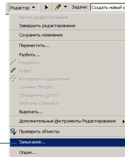
Появляется окно Параметры замыкания. Поскольку вы создаете объект-размер для отображения расстояния между двумя гидрантами, вам понадобится установить замыкание на вершины гидрантов.
