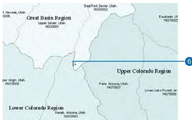
Теперь ребро выбрано и изменило цвет. Если вы включите в ArcMap опцию отображения невыбранных топологических узлов, в местах пересечений ребер полигонов отобразятся прозрачные кружки. Это невыбранные узлы топологии карты.
