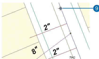
10. Когда курсор замкнулся на трубу, щелкните один раз, чтобы начать создание новой подводящей трубы гидранта.
