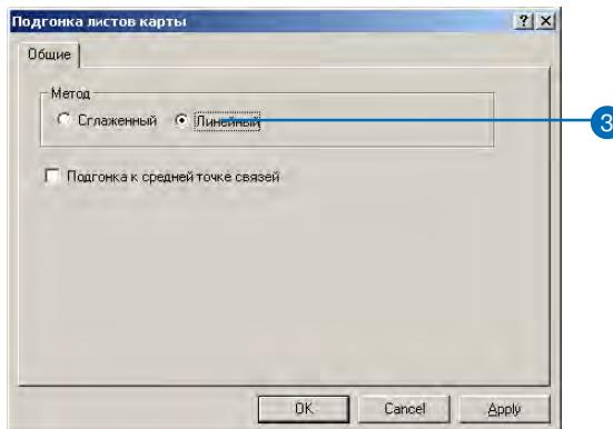
При использовании Линейного метода подгонки сдвигается только конечная точка трансформируемой линии. Если используется Сглаженный метод, то преобразование распространяется на весь объект.
