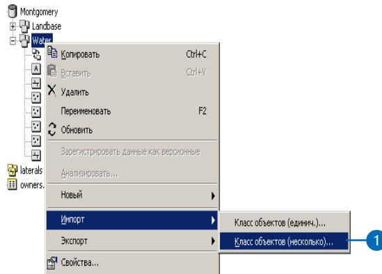
Вы будете использовать инструмент Импорт Класса пространственных объектов для импорта дуг из покрытия Lateral в набор классов объектов Water. Для запуска этого инструмента на вашем компьютере должен быть установлен Python, в ином случае воспользуйтесь инструментом Импорт Класса объектов (единичных), который не требует установки Python.
