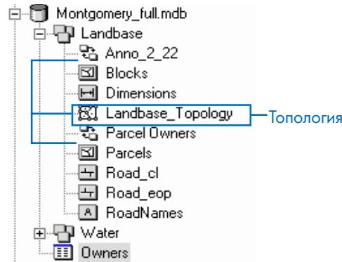
Landbase\_Topo представляет топологию в наборе классов. Эта топология обеспечивает правила, которые определяют, как объекты полигонов в классе Parcels могут быть пространственно связаны друг с другом, и как один из подтипов класса Parcels может быть связан с одним из подтипов класса Blocks. Установка топологии помогает вам поддерживать высокую точность пространственных данных в вашей базе геоданных. Более подробно о топологии смотрите главу “Топология” в руководстве *Построение баз геоданных*.
