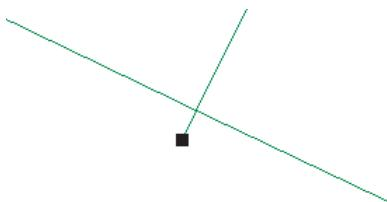
Это ошибка-“перелет”, которая довольно часто встречается в наборах линий, импортированных из данных САПР, или оцифрованных при выключенных опциях среды замыкания, помогающих контролировать связность линий.
