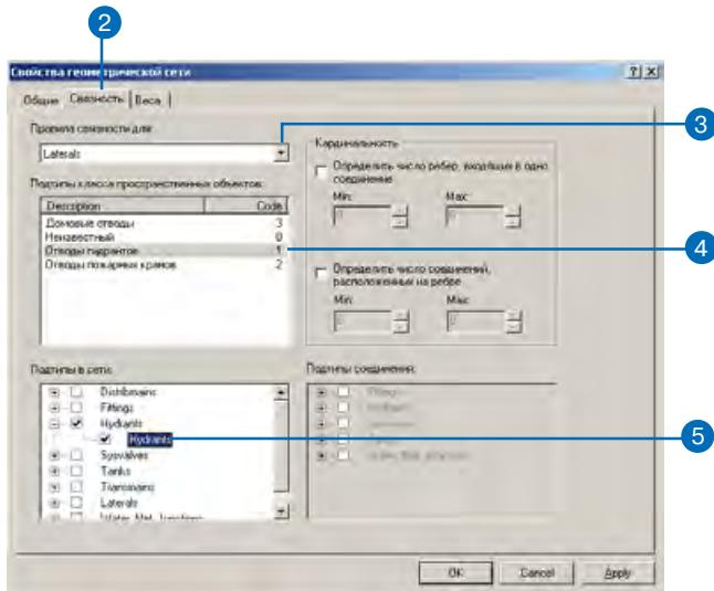
На этой закладке вы можете добавлять и изменять правила связности для геометрической сети. Сначала вы создадите *правило ребро-соединение*, указывающее, что гидранты могут подключаться к отводным трубам гидрантов; оно также будет показывать, что при создании отвода гидранта на его свободном конце должен быть размещен пространственный объект-соединение класса гидрантов.
