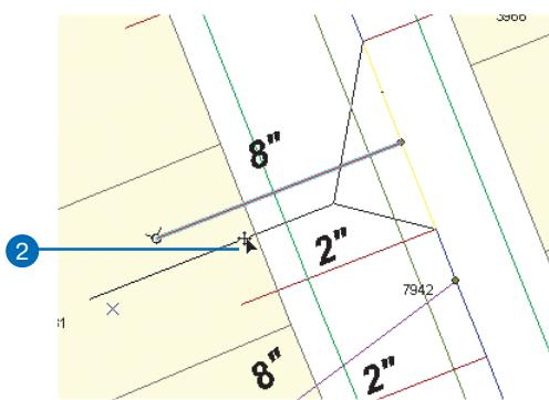
Магистральная труба растягивается, оставаясь соединенной с подводящей трубой. Объект магистральной трубы представляет собой объект сложного ребра - он разбивается в логической сети при добавлении подводящей трубы, но, тем не менее остается единственным объектом в геометрической сети. Аннотация перемещается вместе с объектом.
