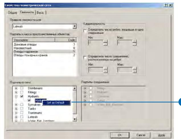
Теперь вам нужно выбрать типы соединений, к которым могут подключаться отводы гидрантов. В целях упрощения примера, отводы гидрантов будут подключаться только к гидрантам.
