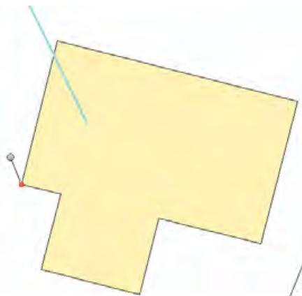
10. Двигайте курсор к верхнему левому углу здания. Дважды щелкните, чтобы замкнуть последнюю точку скетча на угол здания и обрезать линию водопровода.
