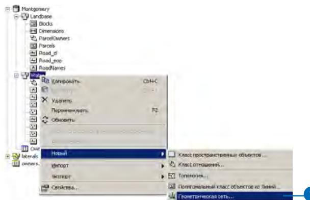
Откроется окно Мастер создания геометрической сети. Используя этот мастер, вы можете построить геометрическую сеть из уже существующих классов пространственных объектов или создать пустую геометрическую сеть. В рассматриваемом примере геометрическая сеть будет построена из уже существующих классов пространственных объектов в наборе классов Water.
