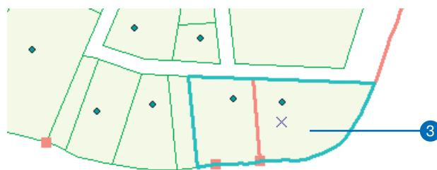
Участки неверно представлены единственным объектом. Точечная ошибка на южном конце линейной ошибки является висячим изломом из-за “недолета”. Вы используете новый способ исправления этой ошибки при помощи инструмента из панели Расширенного редактирования.
