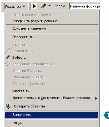
4. Включите замыкание на ребра класса пространственных объектов Hydro\_region, затем закройте диалоговое окно Параметры замыкания.
