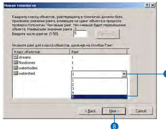
Класс объектов watershed содержит наименее точные данные во всем наборе данных. Они были оцифрованы вокруг водотоков, чтобы обозначить примерные границы. Так как качество этих данных низкое, вы выбрали более низкий ранг - 5. Это предотвратит привязку более точных объектов к объектам класса водоразделов (watershed) при проверке топологии. Все остальные классы объектов имеют одинаковую точность, поэтому им будет присвоен ранг 1.
