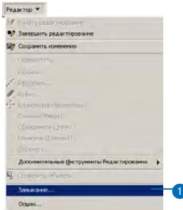
2. Отметьте опцию Ребро для слоя Lotlines, чтобы при оцифровке замыкать объекты на существующие ребра. Закройте диалоговое окно Параметры замыкания.
