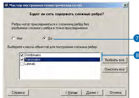
Пространственные объекты, составляющие геометрическую сеть, должны точно совпадать друг с другом. Классы входных объектов могут быть скорректированы для достижения связности с помощью замыкания. Вы должны указать, будут ли пространственные объекты в процессе построения сети корректироваться для того, чтобы обеспечить замыкание.
