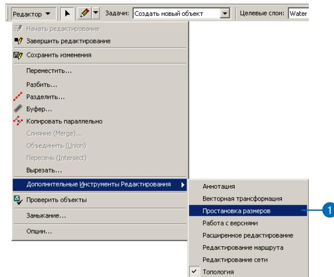
Панель инструментов Простановка размеров позволяет выбрать метод конструирования и стили для новых объектов-размеров.
