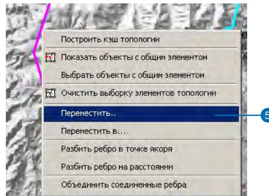
Вы подвинете этот узел на 460 метров по оси x (на восток) и на 410 метров по оси y (на север).
