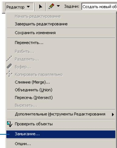
Вы можете замыкать на разные части объекта, редактируемого скетча или на топологические узлы. Вы будете устанавливать параметры замыкания так, чтобы привязываться к топологическим узлам.
