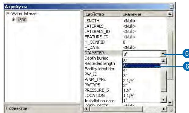
Эта база геоданных включает домен кодированных значений стандартных диаметров труб. Поле диаметра для подводящих труб гидранта ссылается на домен значений диаметра. На один и тот же домен кодированных значений может ссылаться несколько разных классов объектов.
