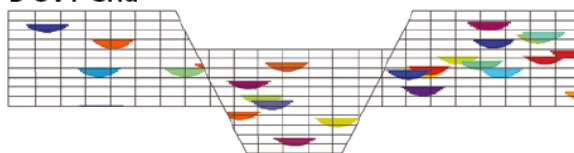
Рис. 1 (А) вертикальный разрез вертикально организованного грида и грида (В) UVT. Непрерывность песчаных горизонтов нарушена в вертикально организованном гриде.
