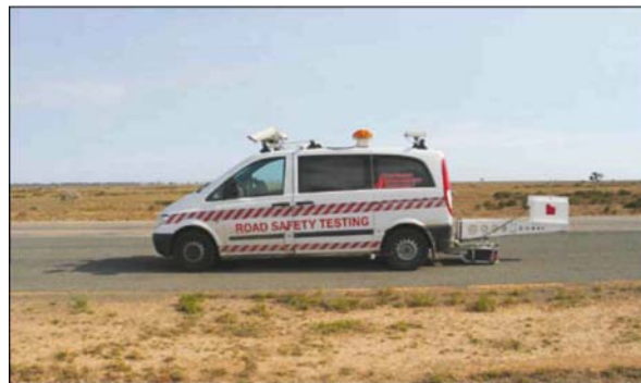
Рис. 4 Проверка дороги с помощью наземного проникающего радара по Австралийской программе REVEAL
