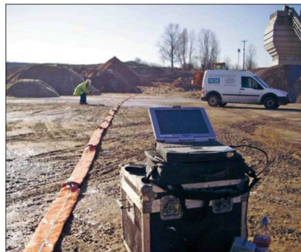
Рис. 7 Метод преломленных волн, использующий сухопутную сейсмическую косу на активно действующем гравий-перерабатывающем комбинате.
