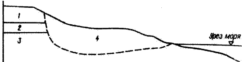
Рис. 43. Типовой инженерно-геологический разрез подрайона П-А-м-3. Пачки пород:
