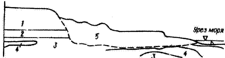
Рис. 46. Типовой инженерно-геологический разрез подрайона III-A- m-4 (Отрада). Пачки пород:
