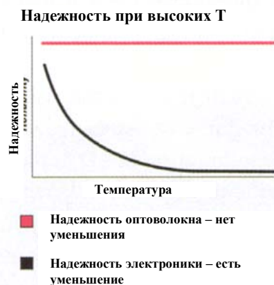
Рис. 5 Температура играет большую роль в надежности стационарных систем мониторинга. При использовании электронной системы, надежность экспоненциально падает по мере увеличения температуры; однако, при использовании оптических систем, которые сделаны из стекла и не включают в себя скважинную электронику, надежность не падает. Стекло не изменяет свои свойства при высоких температурах в скважине.
