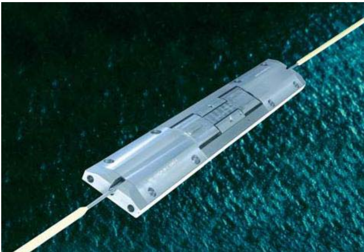
Рис. 3 Внутрискважинная сейсмическая станция включает в себя прочные оптические сенсоры маленького размера, расположенные в твердом, плоском, защитном корпусе. Корпус системы монтируется в свечу обсадной или эксплуатационной колонны с помощью оправки или втулки.
