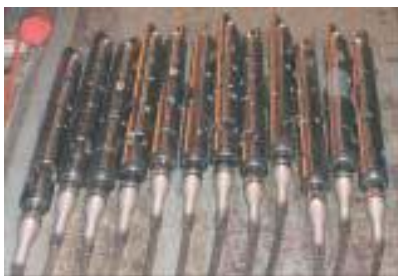
Рис.1. Многокомпонентный зонд ВСП с несколькими приемниками
