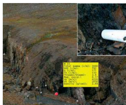
Рис. 6. На участке Фестнингген по 200-метровому профилю вдоль берега получены и введены в SVALSIM петрофизические данные. На фото белыми кружками показаны точки измерения. Щелчок левой кнопкой мыши на одной из этих точек активизирует ее (красный кружок) и показывает данные измерений (гамма-активность, магнитная восприимчивость, скорости упругих волн и плотность) в желтом поле. Щелчок правой кнопкой выводит детальное фото активной точки.
