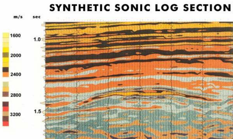
Рисунок 10 Интегрирование сейсмических трасс выполняется в предположении, что плотность постоянна и равна двум. Высокочастотные вариации основаны на диаграммах акустического каротажа и добавляются к тренду скорости, полученному по данным сеймики. Таким образом, все трассы сейсмического разреза переводятся в кривые псевдоакустического каротажа (модифицировано по Yilmaz 2001).
