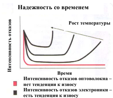
Рис. 4 Электронным датчикам присуща классическая «ванная» характеристика износа. Имеет место выход из строя в начальный период эксплуатации; следующий за ним период характеризуется уровнем стабильности и окончательно приходит фаза полного износа оборудования. Фаза полного износа характеризуется случайным и резким ростом интенсивности отказов. Чем выше рабочая температура, тем раньше придет фаза полного износа.
