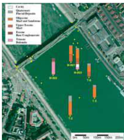
Рисунок 2 Скважинная информация явно указывает на присутствие триасовых доломитов на небольшой глубине под речным дном
