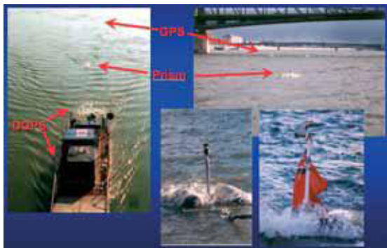
Рисунок 4 Расстановка многоканальной системы сбора сейсмических данных. Стрелками помечены антенны DGPS, установленные на пароме, антенны GPS на хвостовых буйках и призма над источником. На небольших вставках отмечены установки GPS и призм на хвостовом буйке и источник, соответственно.
