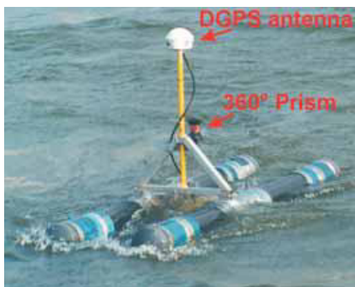
Рисунок 3 Система позиционирования при проведении одноканальной съемки является комбинацией DGPS и лазерного авто теодолита. Обе системы позиционирования установлены на опорной точке над точкой ОИТ одноканальной ультра высокоразрешающей сейсмической системы.
