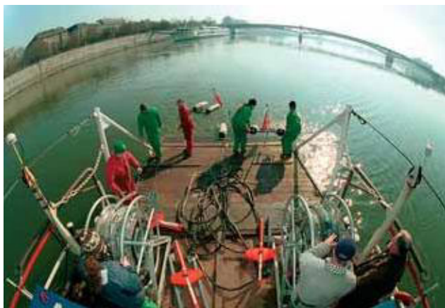
Рисунок 6 Начало профиля высокоразрешенной многоканальной съемки. (Фото любезно предоставлено Гуала Том, МТИ фото)
