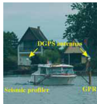
Рисунок 10 Одновременное выполнение сейсмических и георадарных наблюдений surveys.
