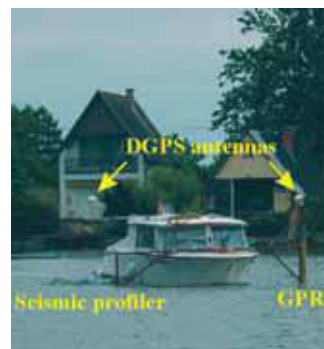
Рисунок 10 Одновременное выполнение сейсмических и георадарных наблюдений surveys.
