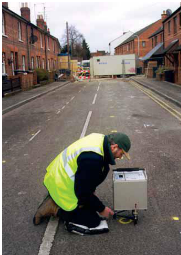
Рис. 1. Работа с высокоточным гравиметром в районе Филд Роуд, г. Реддинг. На заднем плане – зона обрушения.
