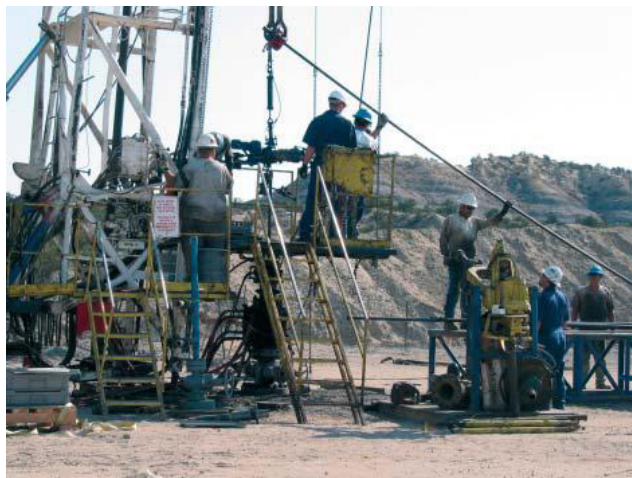
Рисунок 3 Буровое оборудование, развертываемое на насосно-компрессорной колонне, к которой прикреплена скважинная приемная расстановка.
