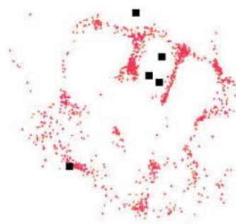
Рисунок 8 Местоположение зоны смятия по данным микросейсмомониторинга месторождения Экофиск, 1997
