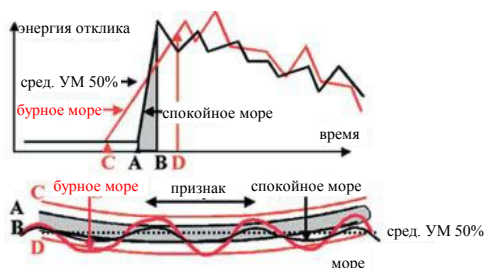
Рис.4. Схема изменения формы отраженного сигнала при изменении состояния поверхности моря. Средний уровень моря (ср. УМ) определяется по 50% уровню падающего (AB для спокойного моря) и возникающего (CD для бурного моря) сигнала. Спокойная поверхность моря показана черным, бурная – красным.
