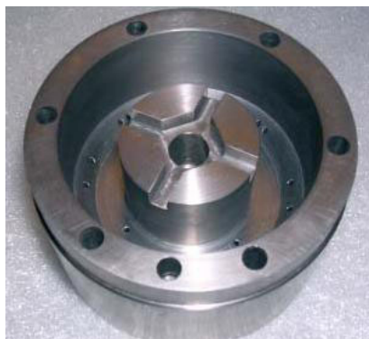
Ниобиевый акселерометр в сборе, готовый к монтажу
