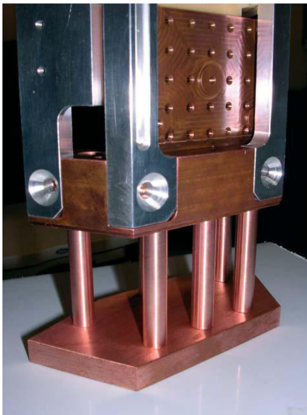
Станина, подготовленная для монтажа сверхпроводящего контура при -269^{\circ}\text{C}
