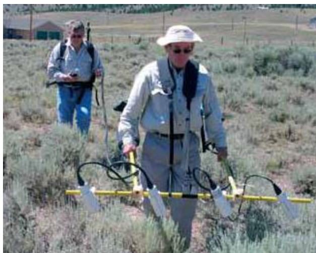
Работы по методу дозвуковой магниторазведки при поисках НРБП в долине Хелена, штат Монтана. Используется счетверенный переносной датчик.
