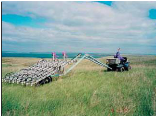
Восьмиканальная буксируемая сборка магнитометров при поисках НРБП на открытой местности (Южная Дакота).
