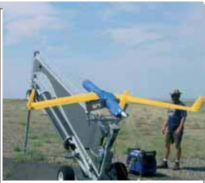
Запуск БЛА с помощью SuperWedge (слева) и посадка с помощью системы Skyhook (справа)
