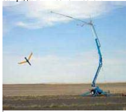
Запуск БЛА с помощью SuperWedge (слева) и посадка с помощью системы Skyhook (справа)
