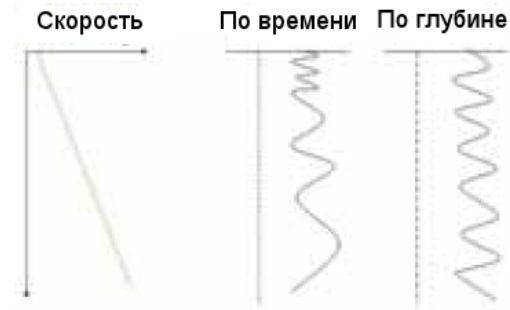
Рис. 11 Схематический рисунок на котором изображении сейсмическая трасса по глубине (в центре) и по времени (справа) для профиля интервальных скоростей (слева). Пунктирная линия рядом с трассами связывает две области и демонстрирует исключение аляйсинга. Другими словами, во временной области можно работать с меньшим числом дискретов благодаря постоянству центральной частоты на записи.
