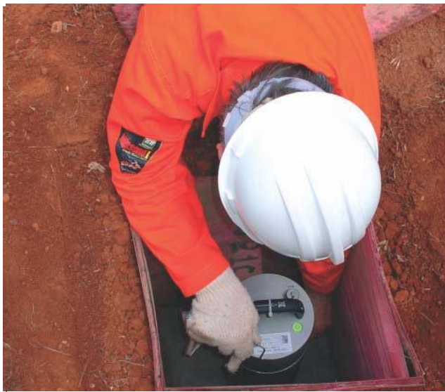
Рис. 2 Подготовка датчика перед измерениями
