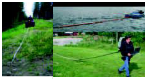
Рис. 3. Варианты использования АПМ. При работе с воды антенну помещают в пластиковую трубу.
