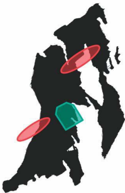
Рис. 8. Карта Западной газовой провинции Troll. Черная область представляет собой область проведения 4D обработки; красные области - места установки платформ; данные с этих областей в базовом наборе были исправлены при создании мониторингового набора данных. Зеленые области - области, где был сделан 4D анализ.
