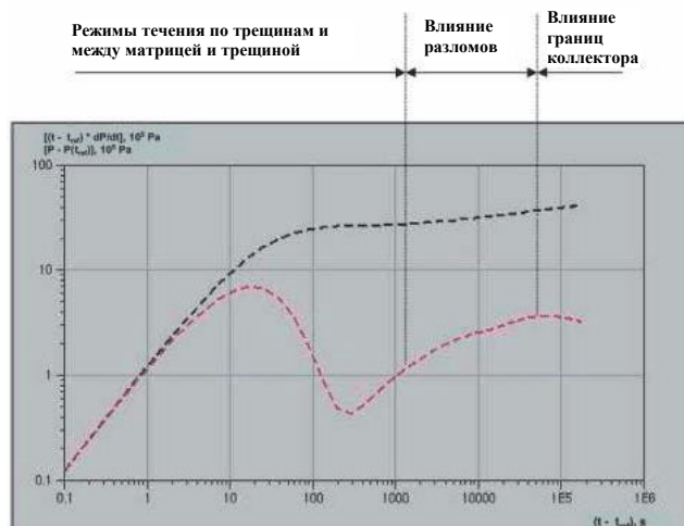
Рис. 5. Моделирование скважинного испытания на трещинном коллекторе, пересеченном разломами в рамках дискретной (геологической) модели ( t_{эф} — время начала откачки)
