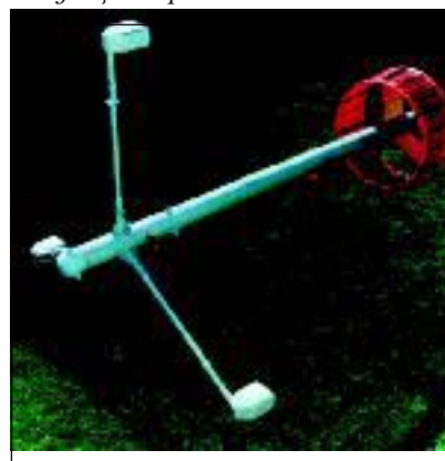
Рис. 4 Полностью собранный аппарат, готовый к проведению аэромагнитных исследований.
