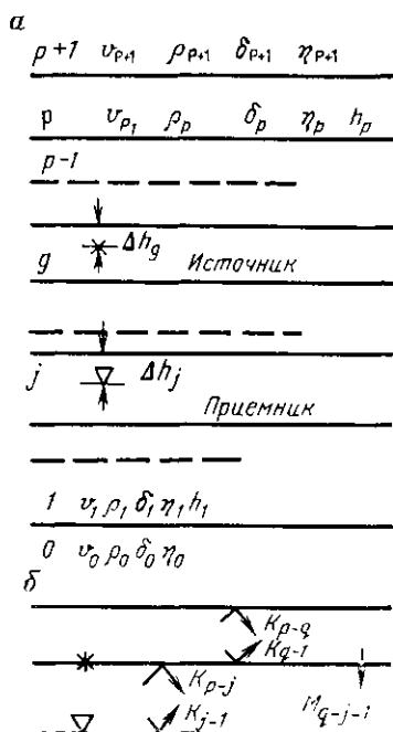
Рис. 31. Схема строения многослойной среды ( a ) и двухслойная эквивалентная модель ( б ), используемая для определения частотной характеристики
