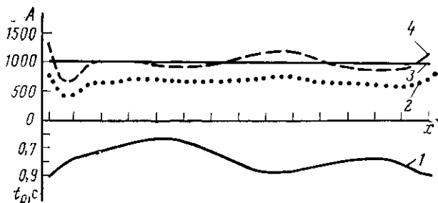
Рис. 40. Изменение вдоль разреза амплитуды отражения от границы (1) с постоянным коэффициентом отражения до (2) и после коррекции амплитуд за геометрическое расхождение, выполненной с учетом (3) и без учета (4) формы границы
