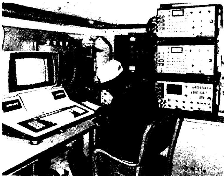
Рис. 5.37. Цифровая полевая аппаратура, смонтированная в автомобиле; регистрирующая система включает некоторые специальные устройства для обработки данных. [С разрешения TI]
