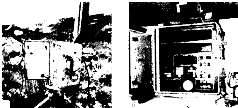
Рис. 5.40. Система Опсейс. Система дает возможность последовательно регистрировать до 4 профилей при 2 расстановках на профиль и 1016 каналов на расстановку. а — выносной телеметрический блок обслуживает 4 группы сейсмоприемников. Сейсмические трассы накапливаются в автономной памяти блока, пока из центрального блока не приходит инструкция об их пересылке. Это дает возможность использовать один радиоканал для многих удаленных блоков, а также обойти ограничения скорости регистрации данных, связанные с протяжкой лент. Система производит автоматическую идентификацию. Взрывник может послать сигнал о взрыве в любой удаленный блок. Если блок перемещается, передается сигнал тревоги, б — программный блок на центральной регистрирующей станции. Клавиатура позволяет оператору вводить данные и инструкции, а панели светящихся диодов выводят информацию для оператора. Связь между центральными и удаленными блоками осуществляется с помощью горизонтально поляризованных волн радиочастотного диапазона. [С разрешения Л. Деизма]
