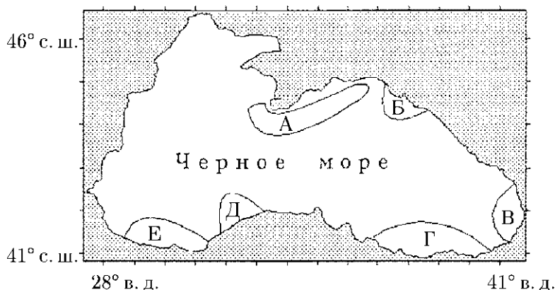
Рис. 10.7. Наиболее вероятные зоны сейсмической генерации цунами в Черном море
