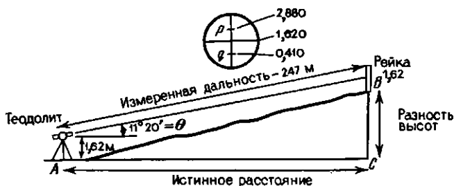
Рис. 1. Применение теодолита для определения диапазона кажущихся наклонов, горизонтальных расстояний и разностей высот
